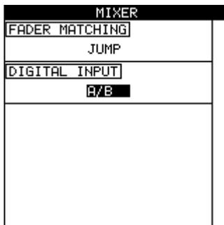
**FADER MATCHING (Faderabgleich)** Mit Hilfe dieser Einstellung bestimmen Sie, auf welche Weise die physischen und die virtuellen Fader zusammenarbeiten (siehe „Fader (Schieberegler“ auf S. 23). Es gibt drei Einstellmöglichkeiten:
