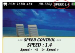
Solange das Dialogfenster **SPEED CONTROL** geöffnet ist, können Sie die Funktion mit **F1** ein- oder ausschalten. Auf diese Weise können Sie schnell zwischen normaler und geänderter Geschwindigkeit umschalten.
