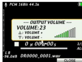
Das Fenster wird nach einigen Sekunden automatisch geschlossen, aber Sie können es auch mithilfe der **F3/HOME**-Taste sofort schließen.
