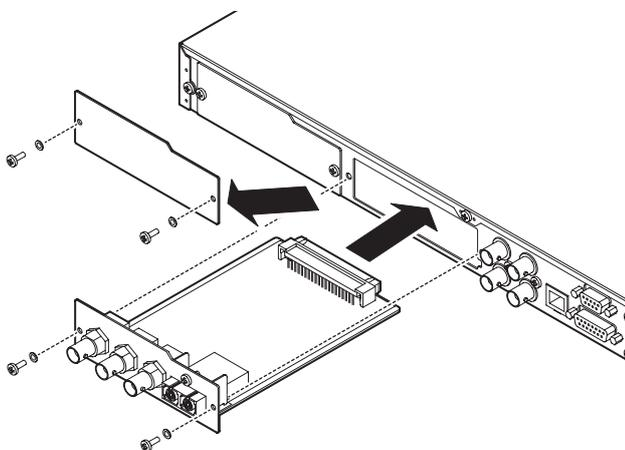
1. Déposer les deux vis du cache de protection et retirez-le (si une autre carte est déjà installée, retirez-la).
