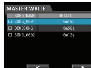
4. **Avec la molette JOG/DATA, sélectionnez les morceaux que vous voulez graver sur CD-R/CD-RW et pressez la touche F2 (✓) pour sélectionner les morceaux désirés (les cases à cocher des morceaux sélectionnés portent un ✓).**
