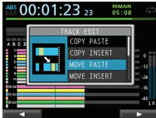
Les données audio comprises entre les points IN et OUT sur la piste source du déplacement sont retirées et collées dans la piste de destination du déplacement à partir du point TO. Cette opération laisse un blanc (silence) sur la piste source du déplacement entre les points IN et OUT.
