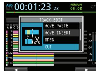
Cette fonction coupe (supprime) les données audio comprises entre les points IN et OUT de la piste sélectionnée et ramène l'enregistrement restant au-delà du point OUT jusqu'au point IN. Par conséquent, la piste se raccourcit.
