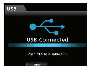
Après avoir fait une connexion USB, vous devez mettre sous tension et activer la connexion USB dans le paramètre USB de l'écran MENU.
