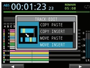
Les données audio comprises entre les points IN et OUT sur la piste source du déplacement sont retirées et insérées dans la piste de destination du déplacement à partir du point TO. Cette opération laisse un blanc (silence) sur la piste source du déplacement entre les points IN et OUT.
