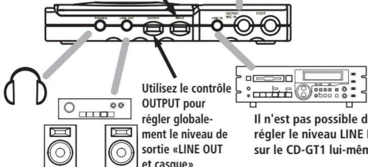
Utilisez le contrôle **OUTPUT** pour régler globalement le niveau de sortie «**LINE OUT** et casque»
