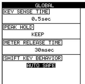
**Tastenempfindlichkeit (KEY SENSE TIME)** Einige der Tasten haben eine doppelte Funktion. Welche jeweils ausgelöst wird, hängt davon ab, ob Sie die Taste nur kurz drücken oder länger gedrückt halten.
