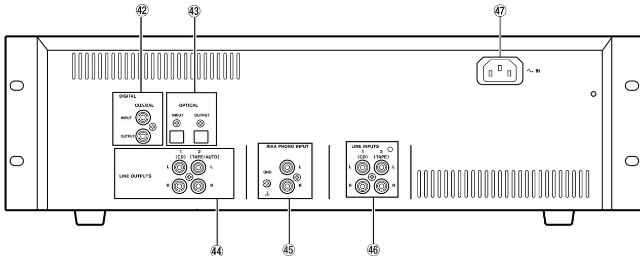
**42 DIGITAL COAXIAL-Anschlüsse** An diesen Koaxialanschlüssen werden Audiodaten im SPDIF-Format für den CD-Recorder empfangen (**INPUT**) beziehungsweise von diesem ausgegeben (**OUTPUT**).
