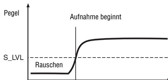
Die Aufnahme endet, wenn der Signalpegel fünf Sekunden lang unter dem Schwellenwert liegt.
