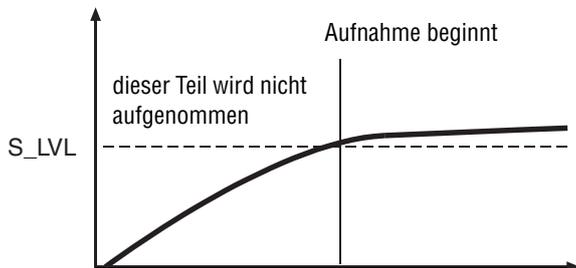
Falls das Grundrauschen des Signals über dem Schwellenpegel liegt, kann keine Synchronaufnahme erfolgen.
