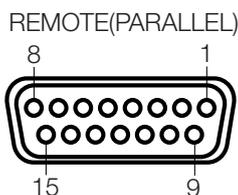
**Eingang:** Eingangssignale müssen mindestens 30 ms lang Low-Potential (Erde) aufweisen
