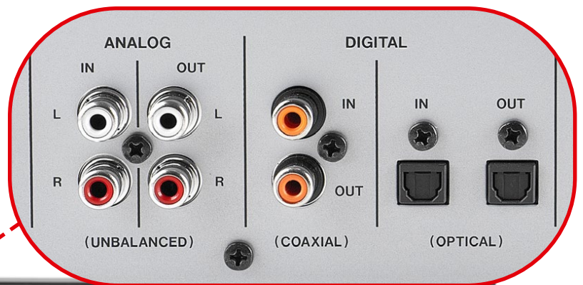
Der Tascam CD-RW900SX verfügt über unsymmetrische Analog-Ein- und Ausgänge sowie über digitale Eingänge im S/PDIF- und TOSLINK-Format. Der Recorder arbeitet mit 16 Bit/44,1 kHz-Auflösung, kann aber auch andere Abtastraten als 44,1 kHz empfangen. Eine Aufnahme ist erst nach Konvertierung der Abtastrate möglich.
