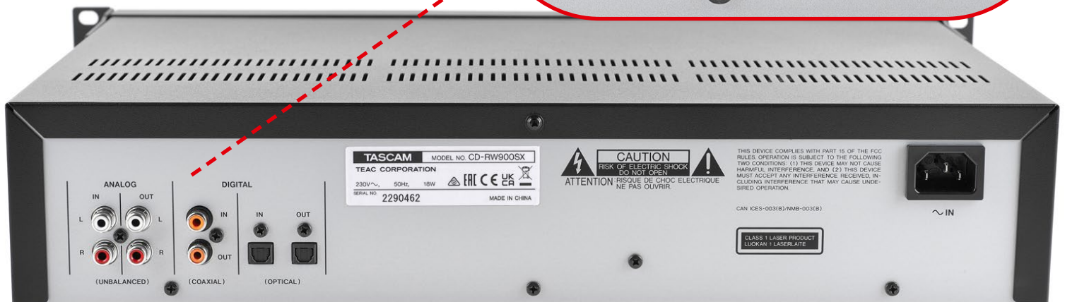
Der Tascam CD-RW900SX verfügt über unsymmetrische Analog-Ein- und Ausgänge sowie über digitale Eingänge im S/PDIF- und TOSLINK-Format. Der Recorder arbeitet mit 16 Bit/44,1 kHz-Auflösung, kann aber auch andere Abtastraten als 44,1 kHz empfangen. Eine Aufnahme ist erst nach Konvertierung der Abtastrate möglich.
