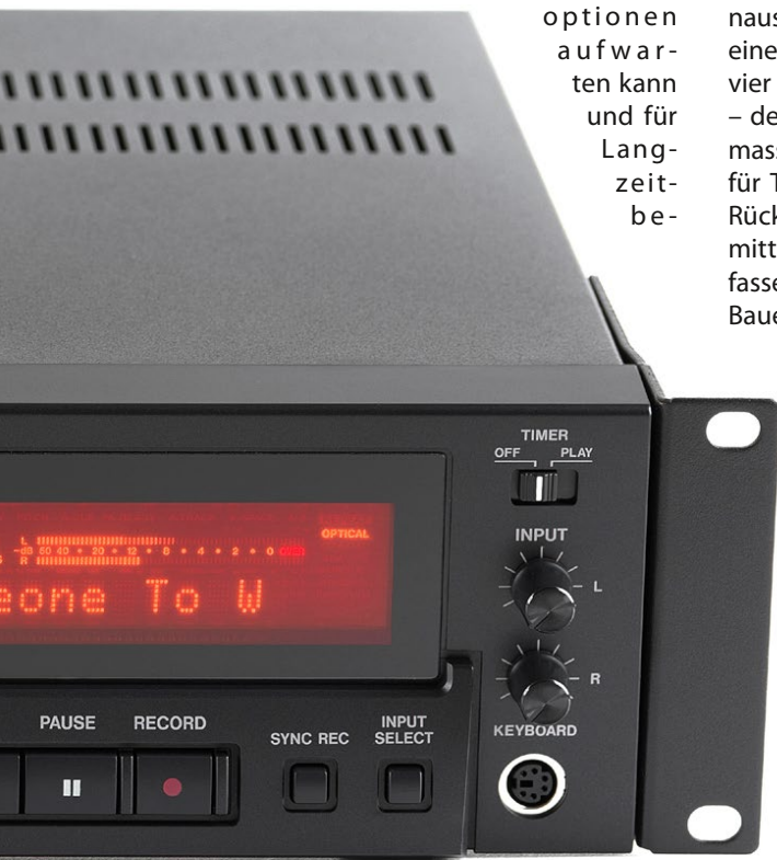
Der Tascam CD-RW900SX verfügt über unsymmetrische Analog-Ein- und Ausgänge sowie über digitale Eingänge im S/PDIF- und TOSLINK-Format. Der Recorder arbeitet mit 16 Bit/44,1 kHz-Auflösung, kann aber auch andere Abtastraten als 44,1 kHz empfangen. Eine Aufnahme ist erst nach Konvertierung der Abtastrate möglich.
