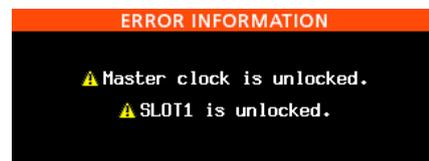
Fehler bei der Synchronisation mit der Masterclock sowie Probleme mit den Kartenschächten **SLOT 1** und **SLOT 2** werden auf diese Weise angezeigt.
