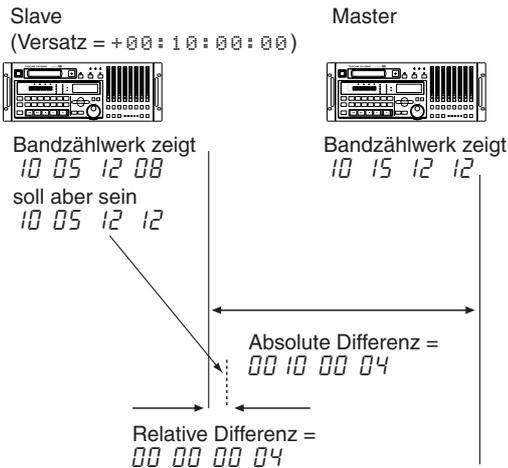
Da der Slave genau 10 Minuten hinter dem Master sein soll, ist also der Unterschied (nämlich +4 Frames) die „relative Differenz“ zwischen dem Master und dem Slave.
