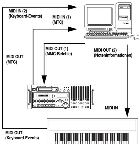
Der Sequenzer wird so eingerichtet, dass er MMC-Befehle sendet und sich zu SMPTE/MTC synchronisiert.
