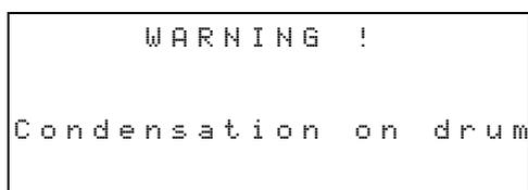
Wenn diese Meldung erscheint, drücken Sie **ESCAPE**, so dass die Meldung erlischt, und lassen Sie den DA-98HR ein bis zwei Stunden eingeschaltet. Schalten Sie ihn anschließend aus und wieder ein, und beginnen Sie erst dann mit der Aufnahme.
