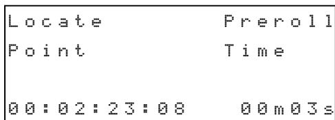
Anschließend läuft das Band an den Locatorpunkt abzüglich der Locator-Vorlaufzeit, wie oben beschrieben.
