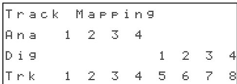
Die beiden oberen Zeilen zeigen die Controllerspuren, die den Spuren des DA-98HR in der unteren Zeile gegenwärtig zugewiesen sind.
