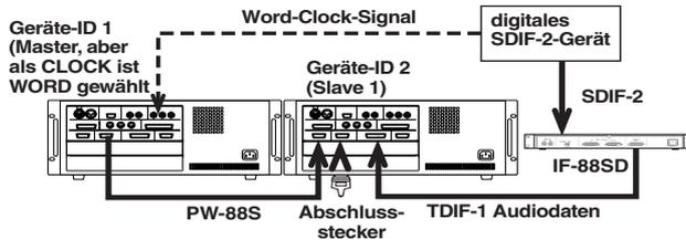
Der Slave erhält zwar sein Wordclock-Signal vom Master, der Master selbst muss jedoch das Wordclock-Signal von dem anderen Audiogerät empfangen.
