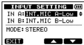
Mithilfe der Einträge **IN A** und **IN B** stellen Sie die Eingangsquellen für die beiden Eingänge **INPUT A** und **INPUT B** ein.
