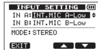
Mithilfe der Einträge **IN A** und **IN B** stellen Sie die Eingangsquellen für die beiden Eingänge **INPUT A** und **INPUT B** ein.
