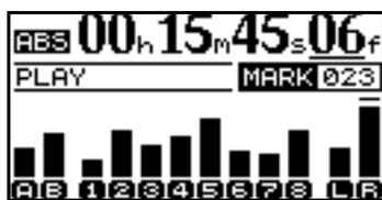
Wichtig ist auch, dass Pegelanzeigen niemals dauernd bis zum oberen Rand ausschlagen sollen. Das würde bedeuten, dass der Pegel zu hoch ist und ziemlich sicher Verzerrungen entstehen. Digitale Verzerrungen sind unangenehm (im Gegensatz zu den Röhrenverzerrungen eines Gitarrenverstärkers), und
