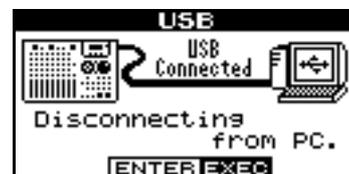
Das DP-02/DP-02CF ist nun so lange für die USB-Verbindung gesperrt, bis Sie **YES/ENTER** drücken, um die Verbindung zu trennen.
