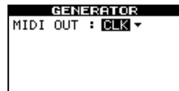
Ab jetzt wird das DP-02/DP-02CF während der Aufnahme und Wiedergabe die hier beschriebenen Befehle am Anschluss MIDI OUT ausgeben. Verbinden Sie den Anschluss MIDI OUT des DP-02/DP-02CF mit dem Anschluss MIDI IN Ihres MIDI-Instruments.
