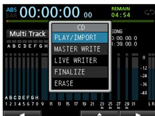
Um zu verhindern, dass während einer Aufnahme Betriebsgeräusche des CD-Laufwerks auftreten, wird das Laufwerk grundsätzlich nur dann mit Strom versorgt, wenn das **CD**-Menü oder eine seiner Unterseiten geöffnet ist. Aus diesem Grund ist es erforderlich, zum Einlegen oder Auswerfen einer CD zunächst das **CD**-Menü aufzurufen. Auch das Laden und Auswerfen einer CD ist nur möglich, wenn das **CD**-Menü oder die **CD PLAY/IMPORT**-Seite geöffnet ist.
