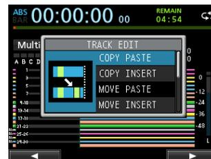
Mit dieser Funktion kopieren Sie das Audiomaterial zwischen dem IN- und OUT-Punkt der Quellspur und fügen es überschreibend am TO-Punkt der Zielspur ein. Der Inhalt der Quellspur zwischen dem IN- und dem OUT-Punkt wird durch den Vorgang nicht verändert.
