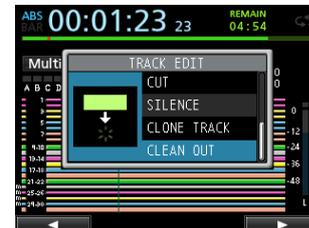
Mit dieser Funktion löschen Sie den Inhalt der ausgewählten Spur vollständig.
