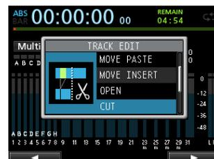
Mit dieser Funktion entfernen Sie das Audiomaterial zwischen dem IN- und OUT-Punkt der ausgewählten Spur(en). Das nachfolgende Material wird nach vorne an den IN-Punkt verschoben. Im Ergebnis verkürzt sich daher die Länge des Audiomaterials auf dieser Spur.
