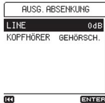
2. Wählen Sie unter **LINE**, mit welchem Pegel das Signal ausgegeben werden soll.
