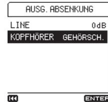
2. Wählen Sie unter **KOPFHÖRER** eine Einstellung für den Pegel des Kopfhörerausgangs (Ω).
