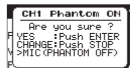
Drücken Sie auf das Rad, um die Phantomspannung für die Eingangsbuchse des entsprechenden Kanals einzuschalten und das dort angeschlossene Mikrofon mit Phantomspannung zu versorgen.
