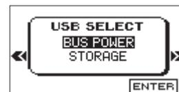
2. Wählen Sie mit Rad die Option **BUS POWER**, und drücken Sie auf das Rad, um die USB-Verbindung für die Stromversorgung zu nutzen.
