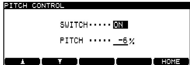
Abbildung 4.2: Tonhöhe/Geschwindigkeit ändern (Pitch-Control)
