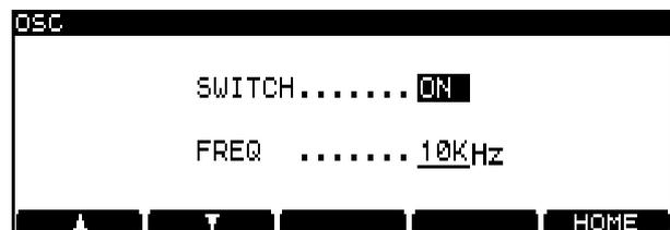
Abbildung 4.5: Einstellungsseite für den Oszillator
