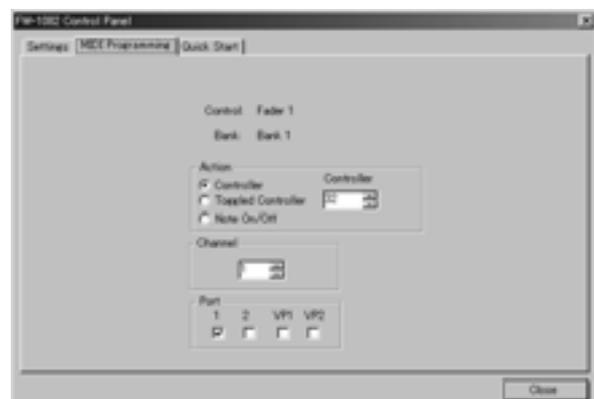
Abbildung 4.8: Fader programmieren
