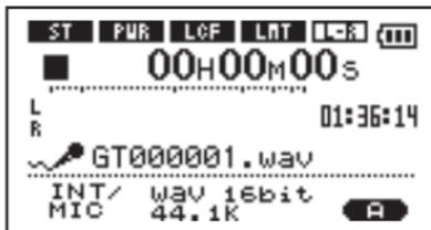
Auf dem Display erscheinen der Name, das Format und die Abtastrate der Aufnahme­datei sowie die Eingangsquelle.
