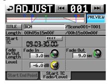
5 Tippen Sie auf einen der Regler Fade In, Fade Out oder Level, und ändern Sie die Einstellung mit dem DATA-Rad.
