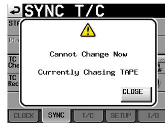
Wenn Sie eine Einstellung ändern wollen, drücken Sie zunächst die **STOP**-Taste, um den Audiotransport zu stoppen. Drücken Sie anschließend die **PLAY**- oder **PAUSE**-Taste, um den HS-8 wieder in den Emulationsmodus zu versetzen.
