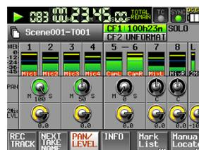
Die **PAN**-Regler der Kanäle, für die als MS-Dekodiermethode **INPUT** gewählt wurde, sind zu Balanceregler für das MS-Signal geworden. Mit diesen können Sie nun die Breite des Stereofelds anpassen.
