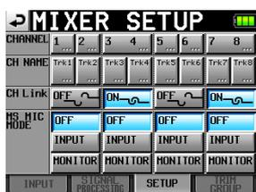
4. Wählen Sie auf dieser Seite unter **MS MIC MODE** die Dekodierungsmethode bei der Verwendung von MS-Mikrofonen. Die Einstellung kann für jedes Kanalpaar (1-2, 3-4, 5-6 und 7-8) separat vorgenommen werden.
