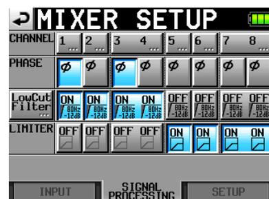
Auf der Registerkarte SIGNAL PROCESSING können Sie die Phasenlage des Eingangssignals umkehren sowie das Trittschallfilter und den Limiter ein- oder ausschalten. Um das Trittschallfilter zu konfigurieren, tippen Sie auf LowCut Filter (die LOW CUT FILTER-Seite erscheint).
