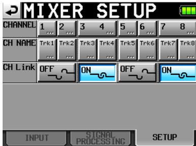
Auf der Registerkarte **SETUP** haben Sie die Möglichkeit, Kanalnamen zu bearbeiten und Kanäle zu koppeln bzw. Kopplungen aufzuheben.
