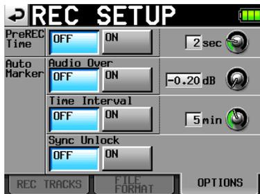
Je nachdem, wie Sie die Auto-Marker-Funktion konfigurieren, können Marken beim Überschreiten eines bestimmten Pegels, in regelmäßigen Zeitabständen oder beim Auftreten von Synchronisationsfehlern automatisch gesetzt werden.
