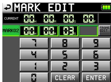
Mit der Schaltfläche FRAME EDIT bestimmen Sie, ob Sie die Position der Marke framegenau bearbeiten wollen. Auf der oberen Abbildung ist die Option deaktiviert, auf der unteren wurde sie aktiviert.
