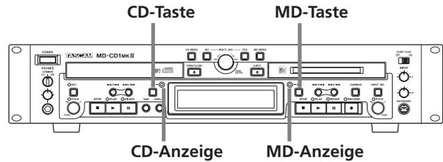
Um von der Fernbedienung aus zu wählen, welches Laufwerk das Display anzeigt, stellen Sie den **CD/MD-Wahlschalter** auf die gewünschte Position, und drücken dann die **DISPLAY**-Taste.
