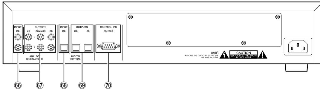
**66 ANALOG INPUT MD** Analogeingang des MD-Laufwerks über Cinch-Buchsen. Schließen Sie hier eine Analogquelle mit Line-Pegel an, um sie mit dem MD-Recorder aufzuzeichnen (z.B. ein Kassetten-deck, den Ausgang eines Mischpults oder eine andere Audioquelle mit Analogausgang).
