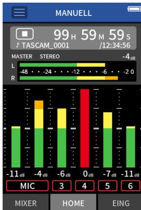
Eine rote Pegelanzeige bedeutet, dass der Eingang übersteuert und das Signal verzerrt sein kann. Nehmen Sie in einem solchen Fall die folgenden Einstellungen vor, um Verzerrungen zu vermeiden:
