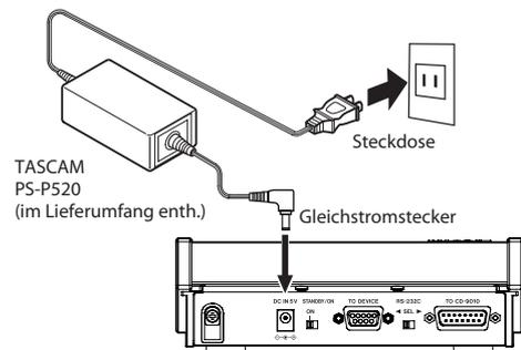
Auf dem hinteren Seitenteil befindet sich eine Kabelführung, mit der Sie das Adapterkabel fixieren können.
