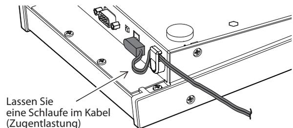
Lassen Sie eine Schlaufe im Kabel (Zugentlastung)
