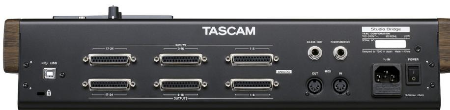
Die Ein- und Ausgänge sind über je drei Sub-D25-Anschlüsse zugänglich, mit jeweils acht Kanälen pro Anschluss. Dabei werden Signale mit Line-Pegel geführt
