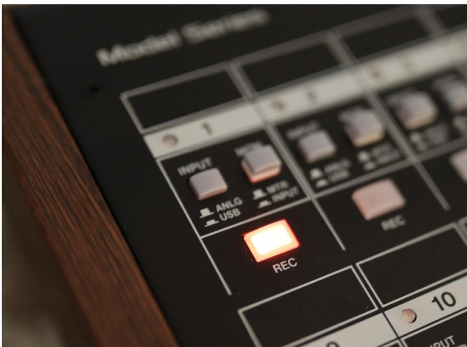
Übersichtlich: In jedem Kanal kann zwischen der Quelle – analoger Input oder USB-Signal – gewählt werden, zudem ist eine Monitor-Funktion vorhanden. Zum Aufnehmen muss die Spur über den Rec-Button scharf geschaltet werden.
