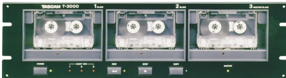
TASCAM stellt mit dem T-3000 einen sehr schnellen Kopierer für Compact-Kassetten vor. Das 19 Zoll breite und 3 HE hohe Gerät, das für den professionellen Einsatz in Tonstudios und Kopieranstalten konzipiert worden ist, kann innerhalb von 7,5 Minuten zwei hochwertige Kopien einer C-60-Kassette herstellen. Dabei überspielt es alle 4 Spuren der Masterkassette gleichzeitig und mit 4facher Normalgeschwindigkeit (19 cm/s) auf die beiden anderen seiner insgesamt drei Laufwerke.
