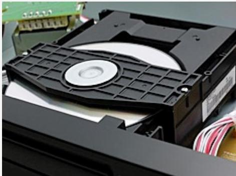
Der CD-240 ist mit demselben hochwertigen CD-Laufwerk aus dem Hause TEAC ausgestattet, das auch in den anderen Modellen der CD-200-Serie verwendet wird. Durch das im eigenen Haus entwickelte Laufwerk wird höchste Zuverlässigkeit gewährleistet.
