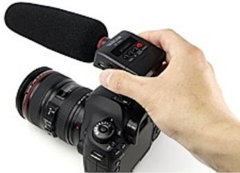
Mithilfe des Blitzschuh-Adapters befestigen Sie den DR-10SG direkt auf der Kamera, wo er am wenigsten stört. Eine schwebende Aufhängung zwischen Blitzschuh und Recorder verringert Vibrationen und Geräusche, die vom Kameragehäuse übertragen werden.
