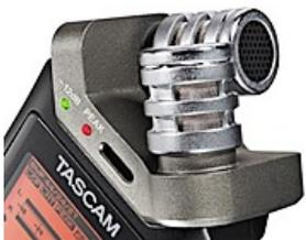
Zwei gerichtete Mikrofonkapseln werden gemeinsam genutzt, um Stereoaufnahmen im XY-Format zu ermöglichen. Sie sind so angeordnet, dass ihre Membranen auf der gleichen Achse übereinanderliegen. Aufnahmen im XY-Format zeichnen sich durch gute Stereoabbildung aus und vermitteln nicht den Eindruck von Leere in der Mitte. Da die Mikrofonkapseln auch bei hohen Pegeln nicht verzerren, sind Aufnahmen mit einem starken Eindruck von Nähe selbst in lautstarken Umgebungen möglich.
