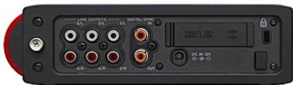
Der Recorder verfügt über einen koaxialen Digitaleingang und -ausgang (SPDIF, AES/EBU) sowie sechs unsymmetrische Lineausgänge. Indem Sie die Ausgänge mit einem Mischpult verbinden, können Sie den DR-680MKII als sechsspurigiges Wiedergabegerät nutzen.
