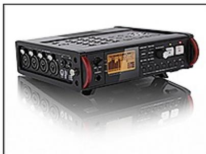
Als Medien für die Aufnahme und Wiedergabe nutzt der DR-680MKII SD-Karten (SDHC, SDXC), die sich durch kompakte Form und hervorragende Beständigkeit gegenüber Vibrationen auszeichnen. Neben dem mitgelieferten Schultergurt verfügt das Gerät über einen klappbaren Standfuß für die Verwendung als Tischgerät, was die Bedienung in einer Vielzahl von Situationen vereinfacht.
