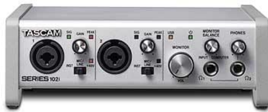
SERIES 102i: USB-Audio-/MIDI-Interface mit DSP-Mixer (10 Eingänge, 4 Ausgänge)
