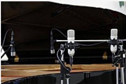
Zusätzlich zu den TM-80-Mikrofonen können Sie auch noch weitere Mikrofone für die Direktabnahme einsetzen. Um einen klareren Klang zu erzielen, platzieren Sie zwei weitere Mikrofone unter dem Deckel in der Nähe der Saiten. Weitere Anteile des klanglichen Spektrums können Sie auch mit Mikrofonen unterhalb des Flügels in der Nähe des Resonanzbodens einfangen.
