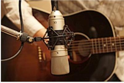
Stellen Sie eines der Mikrofone rund 20 cm vor dem Schallloch der Gitarre auf. Dieses nennen wir das Instrumentenmikrofon. Vergewissern Sie sich, dass die Membran des Mikrofons parallel zur Decke der Gitarre ausgerichtet ist. Sollten hier die Tiefen zu stark betont werden (dröhnender Klang), verschieben Sie das Mikrofon in Richtung des Stegs.
