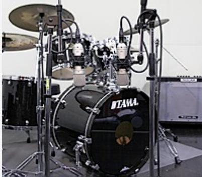
Stellen Sie die beiden Mikrofone wie in der Abbildung im Abstand von rund 20 cm in der Höhe der Bassdrum auf. Da sich die Snaredrum nicht in der Mitte befindet, sollten Sie, um ein ausgewogenes Stereobild zu erhalten, das Mikrofonpaar so ausrichten, dass Bass- und Snaredrum in der Mitte des Stereopanoramas zu hören sind (siehe Abbildung).
