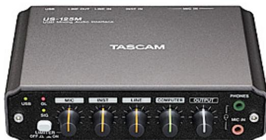
Das US-125M ist ein USB-Audiointerface mit Mixer-Funktionalität. Es vereint ein Mikrofonsignal, ein Instrumenten- und ein Linesignal mit dem Audiosignal eines Computers und leitet die Mischung über USB zurück zu Ihrem Computer. Mit Abtastraten bis zu 48 kHz bei 16 Bit Auflösung ist es ideal für Livestreaming-Anwendungen über das Internet.
