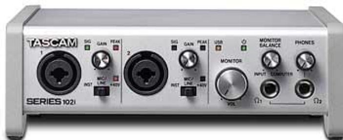
SERIES 102i: USB-Audio-/MIDI-Interface mit DSP-Mixer (10 Eingänge, 4 Ausgänge)
