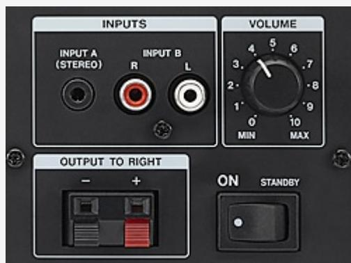
Der eingebaute Leistungsverstärker ist für Desktop-Lautsprecher optimiert. Mit zweimal 14 Watt liefert er nicht nur genügend Leistung für das Abhören mit hoher Lautstärke, sondern sorgt auch für ein ausgeglichenes Klangbild, wenn er leise betrieben wird.
