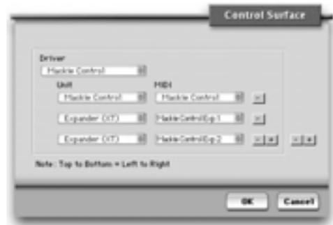
Jeder dieser MIDI-Ports stellt für den Computer eine Bank mit acht Fadern dar. Die äußerste linke Faderbank enthält die Kanäle 1 bis 8 sowie die Bedienelemente des Masterbereichs.
