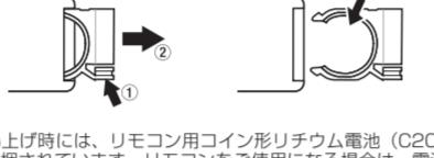
**メモ** 本機をお買い上げ時には、リモコン用コイン形リチウム電池(CR2025)がリモコンに入っている状態で同梱されています。リモコンをご使用になる場合は、電池ホルダーに差し込まれている絶縁シートを引き抜いてください。
