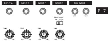
Les entrées du 788 peuvent être directement "routées" vers une voie du mixeur. Elles peuvent également être assignées au mixeur auxiliaire. Au niveau du mixeur principal, chaque entrée peut être assignée à une voie quelconque.
