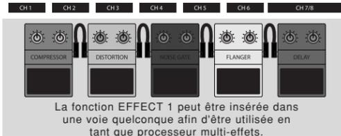
La fonction EFFECT 1 peut être insérée dans une voie quelconque afin d'être utilisée en tant que processeur multi-effets.
