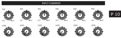
Le mixeur auxiliaire peut être assigné au bus stéréo. Si celui-ci n'est pas utilisé, il peut rester non assigné.
