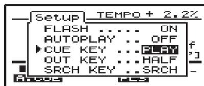
Le réglage peut également être changé en sélectionnant **PLAY** ou **CUE** pour le paramètre CUE KEY du menu Setup.
