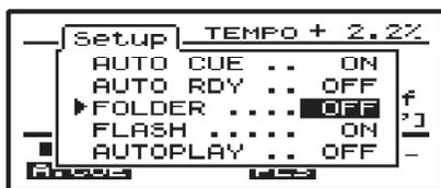
Réglez le paramètre FOLDER sur **OFF** (réglage par défaut) pour sélectionner la lecture complète du
