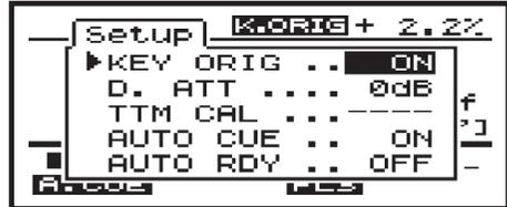
L'indicateur **K.ORIG** apparaît dans l'afficheur quand la fonction Key Original est activée.
