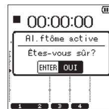
Quand la fenêtre de confirmation s'ouvre, pressez la touche **ENTER/MARK** pour activer l'alimentation fantôme sur la prise **EXT MIC/LINE IN** et ainsi fournir une alimentation fantôme (+24 V ou +48 V) au microphone branché.
