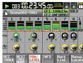
Les boutons **PAN** des paires de canaux dont **MS MIC MODE** est réglé sur **INPUT** deviennent des boutons de balance MS qui règlent la largeur du son.
