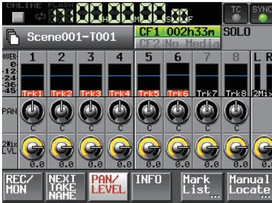
Boutons rotatifs PAN : servent à régler la position gauche-droite envoyée au bus stéréo. Touchez un bouton rotatif et réglez sa valeur avec la molette **DATA**.
