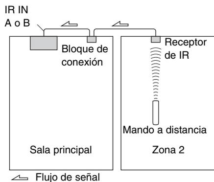
El cable de miniconector del bloque de conexión debería estar conectado a la toma **IR IN A** o **B** del receptor de AV, como se muestra a continuación. Las tomas **IR IN A** y **B** son idénticas. Es posible conectar hasta dos receptores IR.
