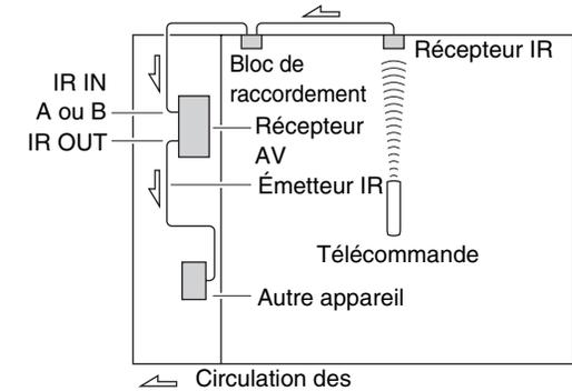
L'émetteur IR doit être branché à la prise **IR OUT** du récepteur AV, comme indiqué ci-dessous.
