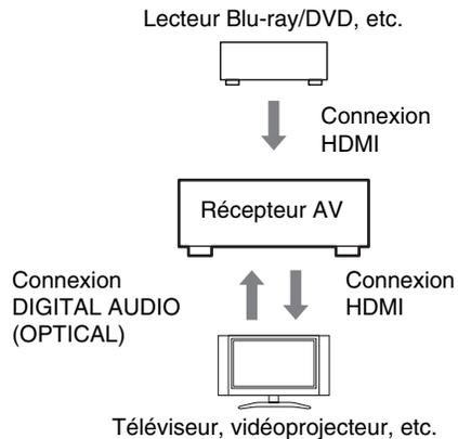
2. Branchez la sortie audio du téléviseur sur la prise **OPTICAL IN 2** du récepteur AV à l'aide d'un câble optique numérique.
