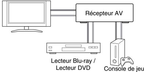
\*1 Si votre TV ne prend pas en charge le canal de retour audio (ARC - Audio Return Channel), vous devez connecter un câble numérique optique ainsi qu'un câble HDMI sur le récepteur AV.
