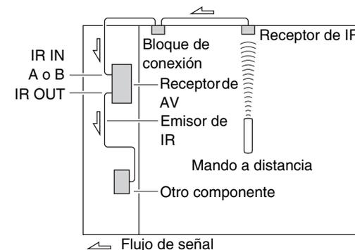
El emisor de IR debería estar conectado a la toma **IR OUT** del receptor de AV, como se muestra a continuación.
