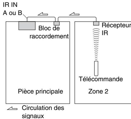
Le câble à minifiche provenant du bloc de raccordement doit être branché à la prise **IR IN A** ou **B** du récepteur AV, comme indiqué ci-dessous. Les prises **IR IN A** et **B** sont identiques. Il est possible de raccorder deux récepteurs IR maximum.
