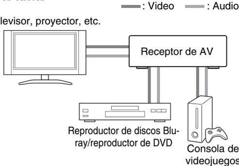
\*1 Si su televisor no es compatible con el canal de retorno de audio (ARC), debe conectar un cable digital óptico además del cable HDMI al receptor de AV.
