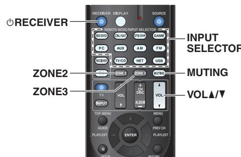
**1 Pulse ZONE2 o ZONE3, apunte el mando a distancia al receptor de AV y pulse ØRECEIVER.**
