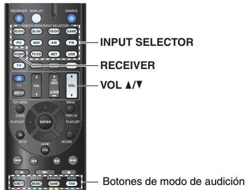
**1** Pulse RECEIVER seguido de un botón INPUT SELECTOR.
