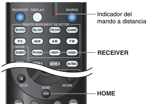
Para reinicializar el mando a distancia a sus valores de fábrica por defecto, manteniendo presionado el botón **RECEIVER**, pulse y mantenga presionado el botón **HOME** hasta que se encienda el indicador del mando a distancia (aproximadamente 3 segundos). Antes de que transcurran 30 segundos, pulse de nuevo el botón **RECEIVER**.
