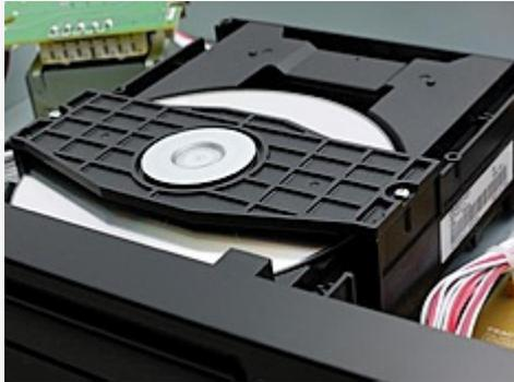
L'appareil utilise la même mécanique de lecture CD fabriquée par TEAC, spécialement conçue pour l'audio, que les autres modèles de la Série 200. L'utilisation d'une mécanique entièrement développée en interne assure une fiabilité maximale.
