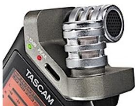
Deux microphones cardioïdes sont utilisés en configuration XY pour un enregistrement en couple stéréophonique. Les deux capsules sont montées de telle façon que les membranes soient coïncidentes en leur centre ("coaxial"). Le couple XY procure une belle image stéréophonique, sans trou au centre. Comme les capsules sont exemptes de distorsion, même à fort niveau de pression acoustique, il est possible d'enregistrer de près, même si les sources sonores sont très fortes.
