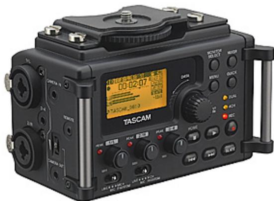
Le DR-60D est un enregistreur numérique audio 4 pistes compact, conçu pour une utilisation avec un appareil photo numérique de type reflex numérique DSLR (*Digital Single-Lens Reflex*) ou DSLM (*Digital Single-Lens Mirrorless*) utilisé comme caméscope. Il se fixe à l'appareil photo, et propose différentes entrées/sorties audio, afin d'enregistrer le son en haute résolution, en parallèle à l'image, mais sur un support séparé de celui sur lequel l'appareil photo stocke les données vidéo.
